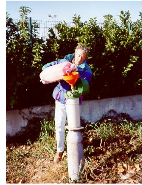
Injection d'un traceur au droit d'un piézomètre
