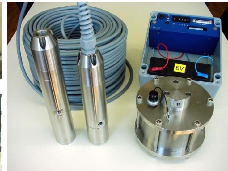
Fluorimètre de forage (gauche) et de source (droite)
